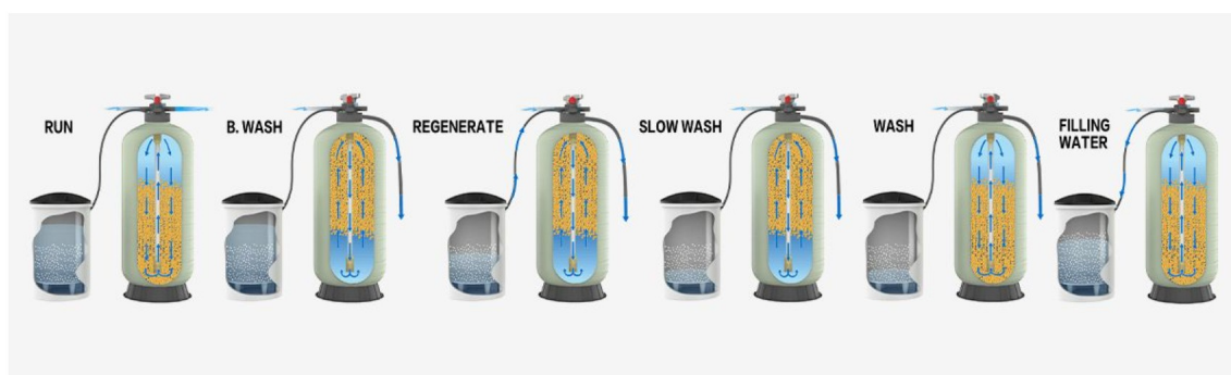
Ciclos de servicio y regeneración de un ablandador
